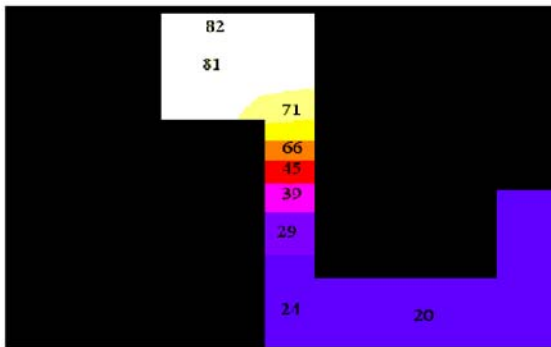
Рис. 6. Температурне поле переднього гальмового диска автобуса А-171 в кінці 1-го циклу охолодження випробовувань I
