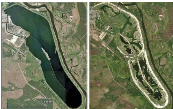
Рис. 7. Супутникові знімки водойми-охолоджувача Чорнобильської АЕС у 2014 р., перед початком спуску води, і наприкінці 2021 р.
