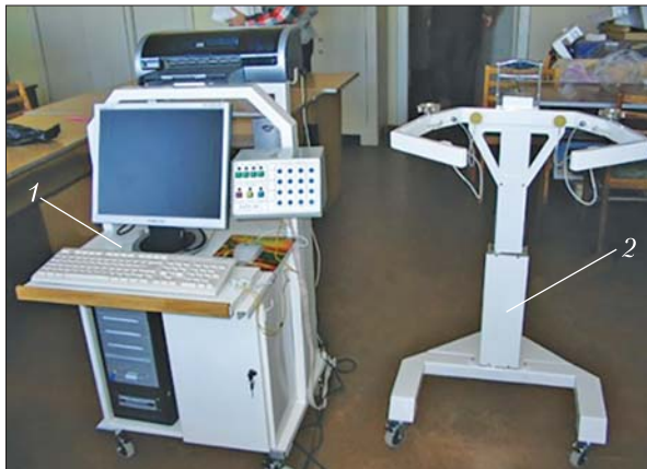
Розроблений в Інституті гідромеханіки НАН України фоноспірографічний комплекс «КоРА-03М1»: 1 – робоче місце оператора; 2 – стійка з п'єзоакселерометрами
