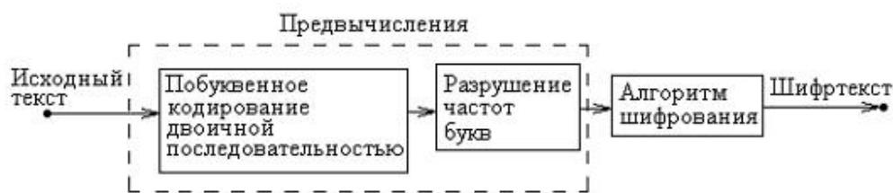
Рис. 1. Положение дискретного преобразователя, разрушающего частоты в схеме шифрования.
