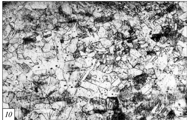
Рис. 3. Мікроструктури металу: 1 — ан. 83, зб. 70; 2 — ан. 84, зб. 70; 3 — ан. 85, зб. 70; 4 — ан. 86, зб. 70; 5 — ан. 86, зб. 120; 6 — ан. 87, зб. 70; 7 — ан. 90, зб. 70; 8 — ан. 90а, зб. 70; 9 — ан. 90б, зб. 120; 10 — ан. 91, зб. 120
