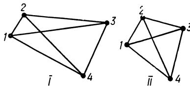
Рис. 2. Конфигурации сетей станций наблюдений ИСЗ
