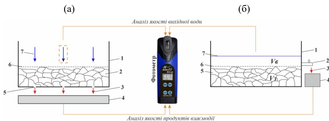
Рисунок 2. Схема експериментальних досліджень взаємодії закладних матеріалів кар'єрних пустот з водними ресурсами: (а) в умовах сухих кар'єрів: 1 – ємність; 2 – закладний матеріал; 3 – фільтрат; 4 – ємність для збору фільтрату; 5 – отвори у днищі ємності; 6 – висота шару закладного матеріалу; 7 – імітація атмосферних опадів; (б) в умовах обводнених кар'єрів: 1 – ємність; 2 – кран для зливу розчину; 3 – розчин; 4 – ємність для збору розчину; 5 – закладний матеріал; 6 – висота шару закладного матеріалу; 7 – рівень заповнення кар'єрною водою; V_в , V_з – об'єми води та закладного матеріалу в ємності відповідно, m^3
