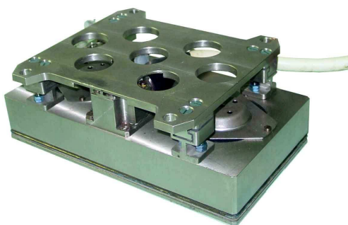
Прибор 1 290x200x102,5 мм, 22 кг (гидроакустическая антенна) лага ЛДУ-160
