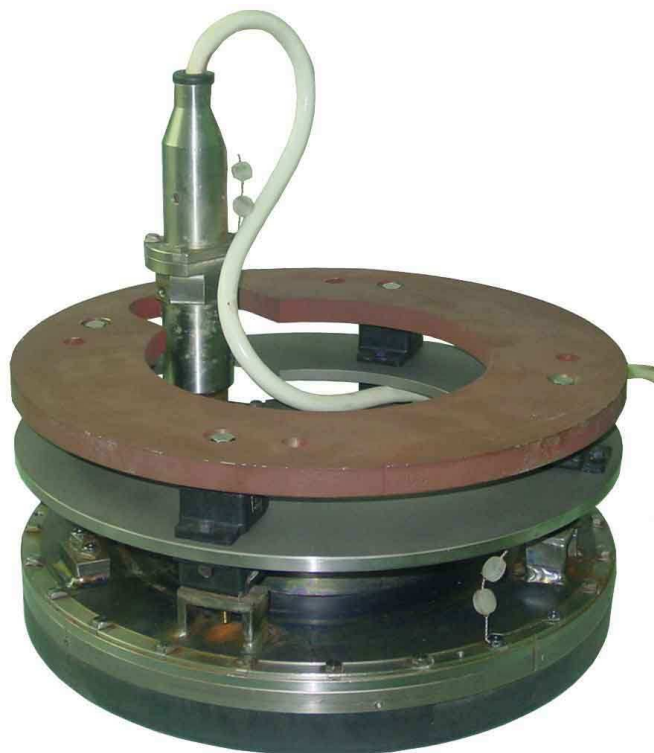
Прибор 1 Ø460x209 мм, 81 кг (гидроакустическая антенна) лага ЛДУ-400
