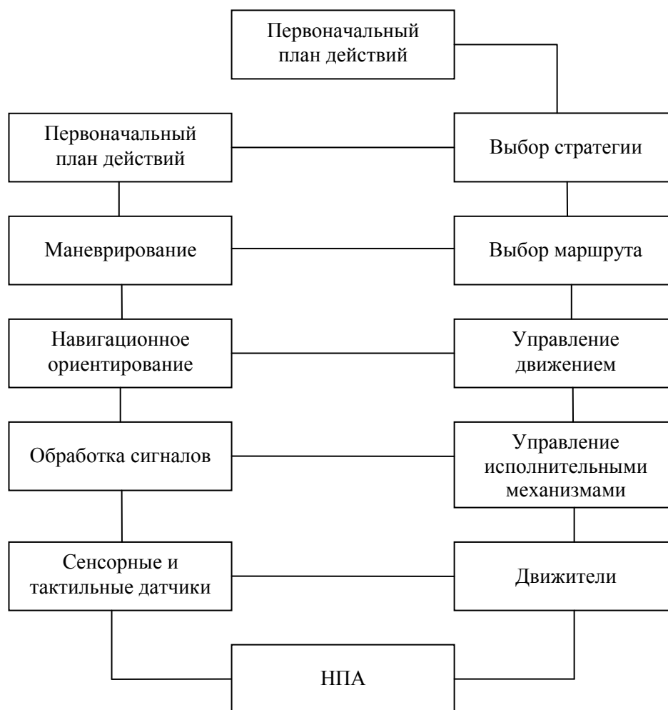
Рис. 13 - Многоуровневая система управления замкнутого типа
