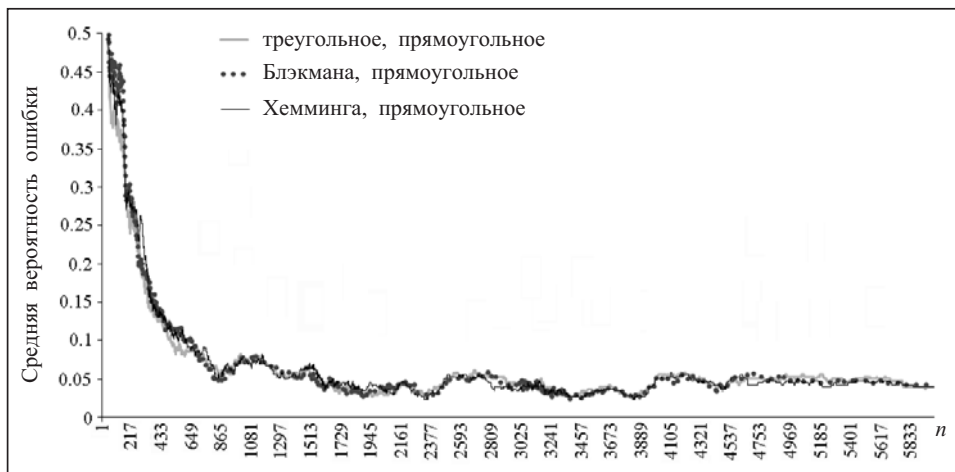
Рис. 5. Динамика изменения EER при идентификации 75 испытуемых по кепстрограмме правого уха в зависимости от используемых оконных функций
