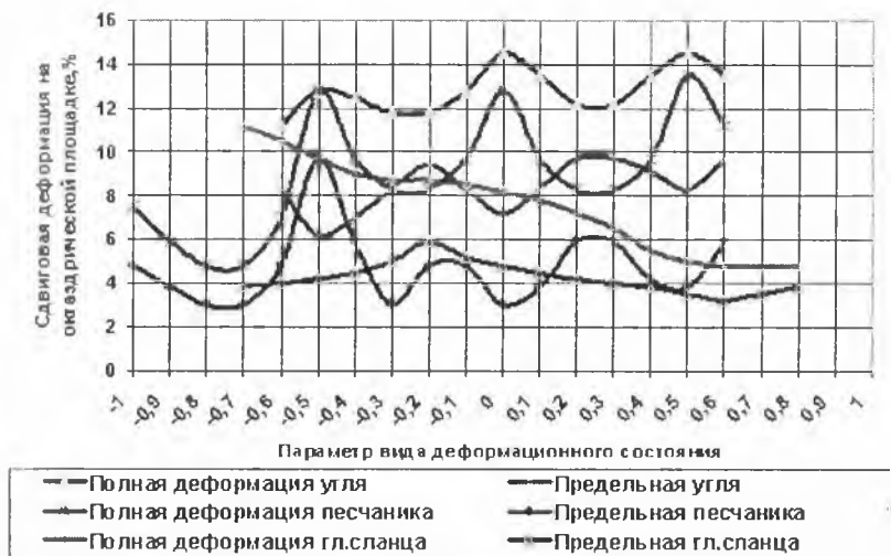
Рис. 5. Зависимость сдвиговой деформации угля и вмещающих пород \gamma от параметра вида деформационного состояния \mu_\epsilon при \sigma_3 = 20 МПа.
