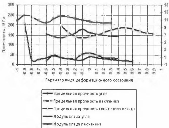
Рис. 2. Зависимость прочности угля и вмещающих пород от величины бокового давления \sigma_0 .
