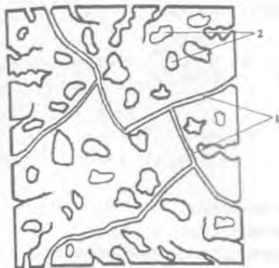
Рис.1. Модель пористой структуры угольной частицы : 1 - открытая пористость, 2 - закрытая пористость.
