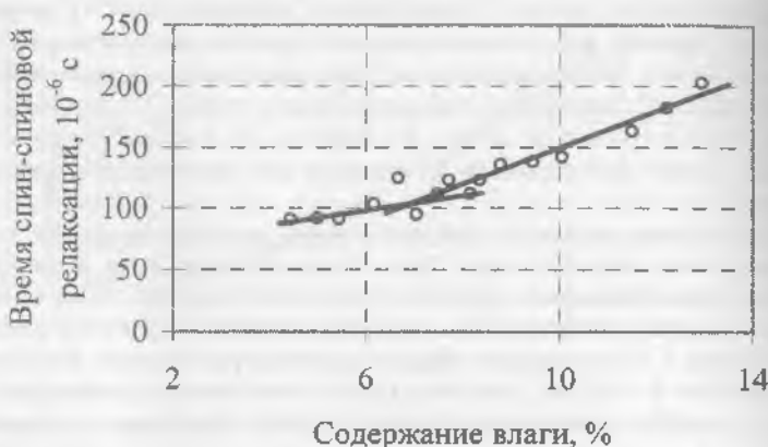
Рис.9. Зависимость времени спин-спиновой релаксации от процентного содержания влаги в угле марки Д.
