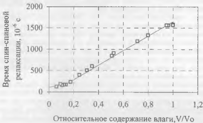
Рис.8. Зависимость времени спин-спиновой релаксации от относительного содержания влаги для силикагеля с радиусом пор 1,4 нм.
