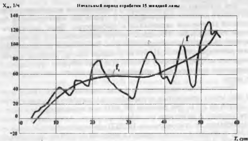
Рис.3. Зависимость показателя «шумности» верха 15 западной лавы от продолжительности очистных работ: 1- основная тенденция в изменении «шумности» во времени; 2- «высшие гармоники» графика изменения «шумности».
