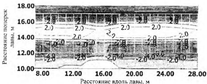
Рис. 16. Распределение касательных напряжений \tau_{yz} (МПа) в кровле пласта от поперечной перерезывающей силы действующей вдоль лавы
