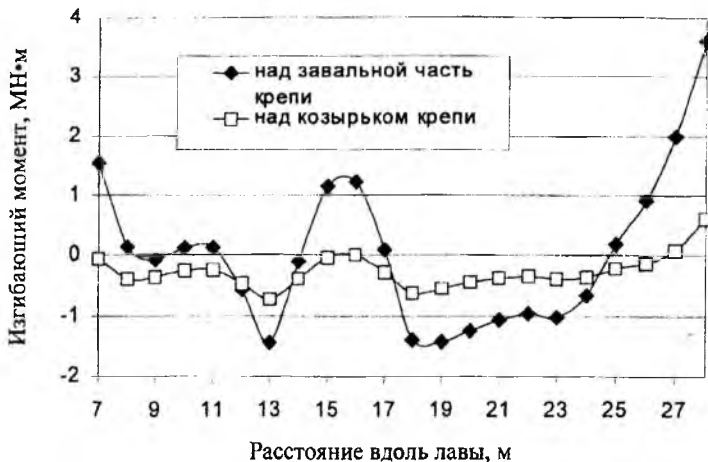
Рис. 7. Показатели изгибающих моментов вдоль лавы в кровле пласта над моделируемыми секциями крепи.
