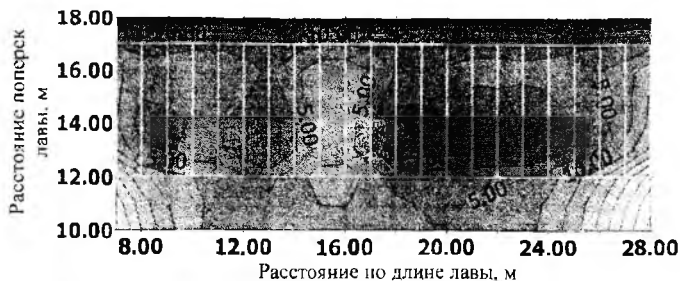
Рис. 10. Изолинии напряжений (МПа) возникающие в непосредственной кровле пласта от изгибающих моментов действующих вдоль лавы.
