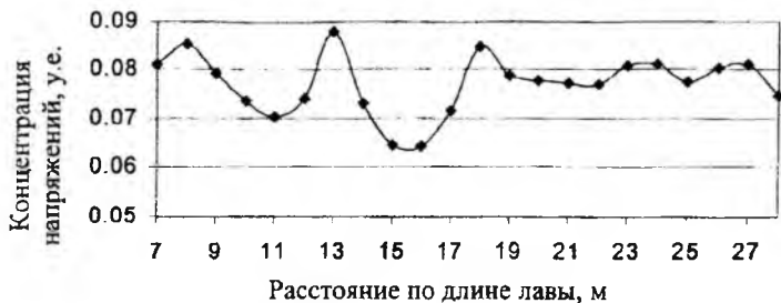
Рис. 5. Показатели концентрации напряжений над задним рядом стоек секций механизированной крепи.
