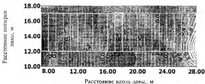
Рис. 9. Распределение крутящего момента M_{xy} в кровле пласта.
