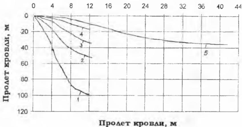
Рис. 4. Опускание и смещение боковых пород по нормали и в плоскости пласта по падению.
