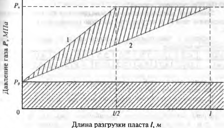
Рис. 1. Изменение давления в призабойной зоне пласта без закладки выработанного пространства (1) и с закладкой (2).
