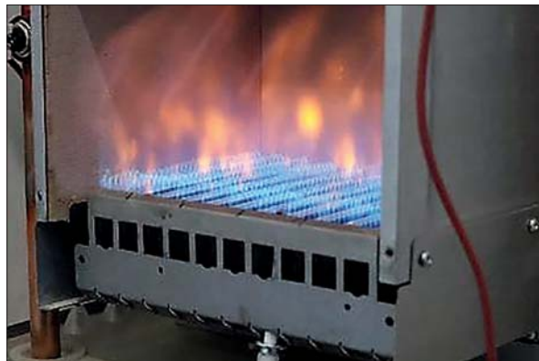
Рис. 5. Установа Інституту газу НАН України для спалювання суміші водню з природним газом
