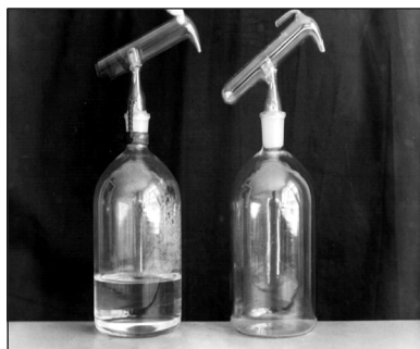
Рис.2. Лабораторний дозатор на 10 мл (праворуч) і виготовлений на його основі прилад для стерилізації насіння (ліворуч)
