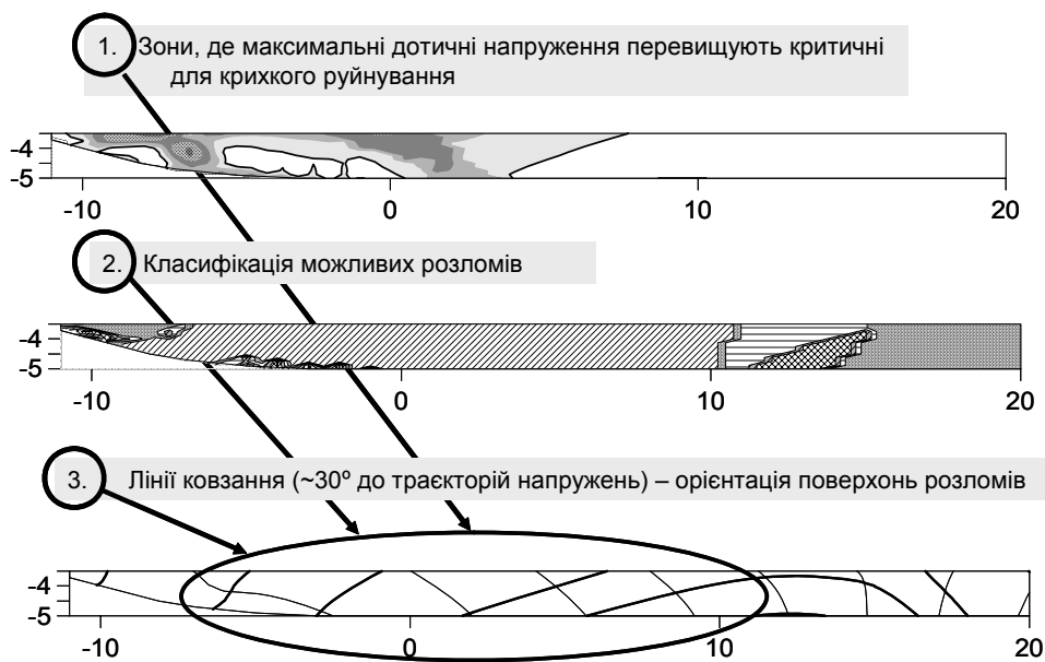
Рис. 8. Комплексна інтерпретації результатів моделювання насувоутворення. Зверху вниз: зони руйнування, класифікація типів розломів, орієнтація ліній сколювання.
