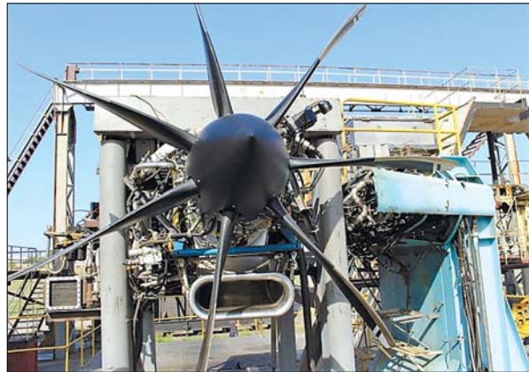
Рис. 6. Відкритий стенд для випробувань повнорозмірних двигунів в умовах навколишнього середовища
