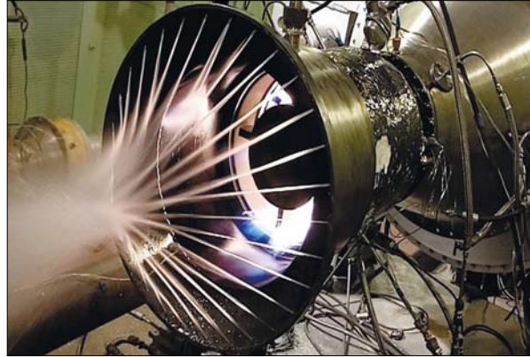
Рис. 5. Стенд для випробувань повнорозмірних камер згоряння
