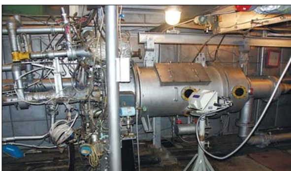
Рис. 3. Автоматизована мала термобарокамера для дослідження систем розпалення камер згоряння
