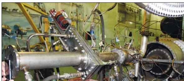
Рис. 4. Установка з одно- і чотиріпальниковим відсіком камери згоряння
