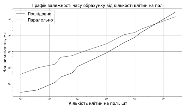
Рис. 17. Графік залежності часу обчислення від кількості клітин на полі.
