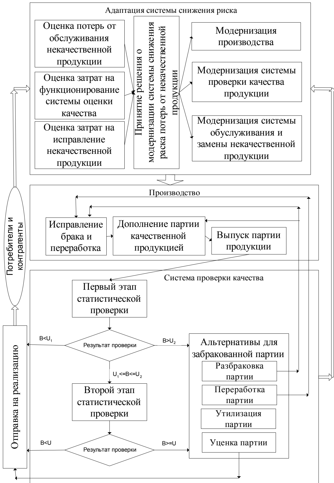
Рис. 3. Механизм снижения риска убытков от выпуска некачественной продукции
