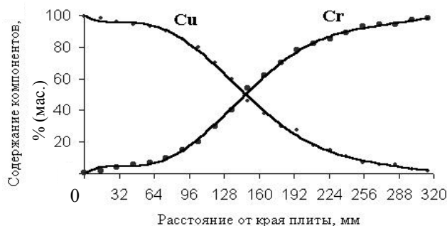
Рис. 1. Изменение химического состава Cu—Cr конденсата вдоль длины плиты.
