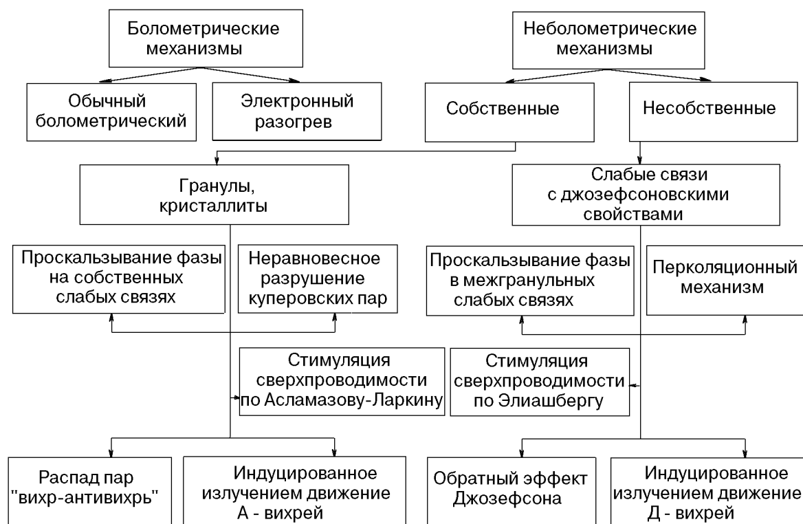
Рис. 1. Механизмы детектирования электромагнитного излучения сверхпроводниками.
