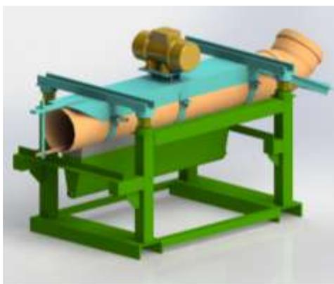
Рисунок 1 – Общий вид обезвоживающего устройства
