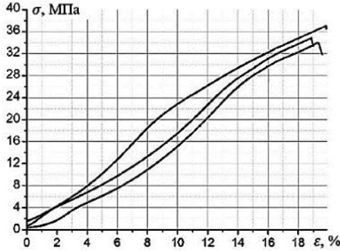
Рис. 4. Кривые деформирования трех образцов при испытании на разрыв со скоростью нагружения 100%/мин.
