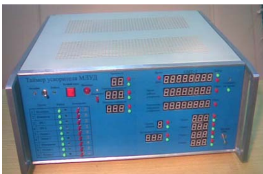
Рис.5. Таймер-синхронизатор ускорителя МЛУД. Внешний вид прибора
