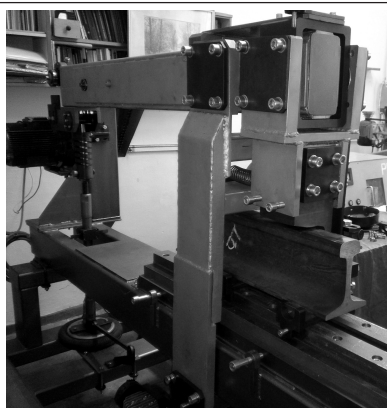
Рис. 1. Установка для дослідження контактної втоми пари колесо-рейка.
