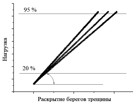
Рис. 3. Изменение нагрузки в зависимости от раскрытия берегов трещины для трех последовательных циклов нагружения.
