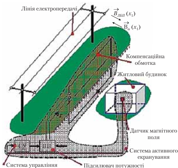
Рис. 3. Схема системи активного екранування (САЕ) для зменшення негативного впливу ліній електропередачі та міських трансформаторних підстанцій на людину і навколишнє середовище
