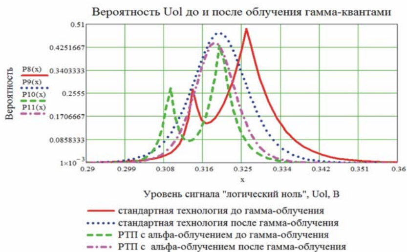
Рис. 5. Вероятность численного значения U_{OL} для ИС, изготовленных с применением \alpha -РТП и по стандартной технологии «кремний с диэлектрической изоляцией» до и после облучения гамма-квантами
