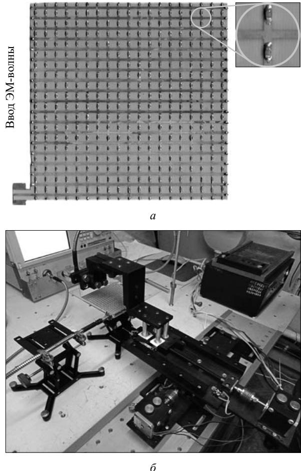
Рис. 1. Фотографии планарного гиперболического метаматериала (а) и экспериментальной установки (б)
