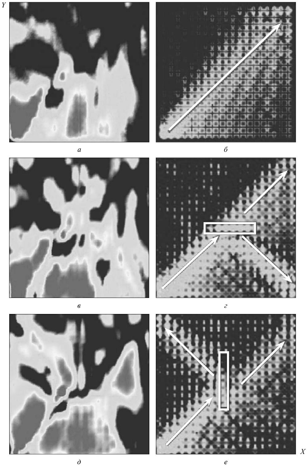
Рис. 2. Результаты экспериментального исследования (слева) и численного моделирования (справа) распределения поля в планарном гиперболическом метаматериале: *a, б* – без дефекта; *в, г* – с дефектом, параллельным оси *X*; *д, е* – с дефектом, параллельным оси *Y*
