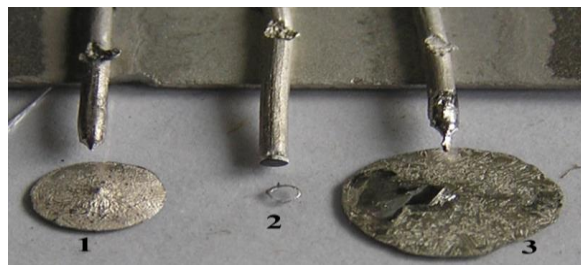
Рис. 4. Формирование расплава на лейкосапфире при 920 °С. Основы припоев массой каждого по 30 мг имеют составы (% (мас.)): 1 — 72Ag—Cu; 2 — 78Ag—Cu; 3 — 70,9Ag—27,5Cu—1,6Ni
