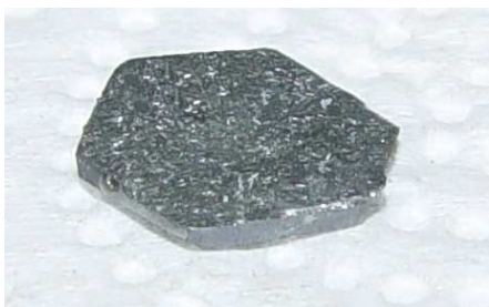
Рис. 2. Образец ZrO_2 -керамики, металлизированный Al_3Ti
