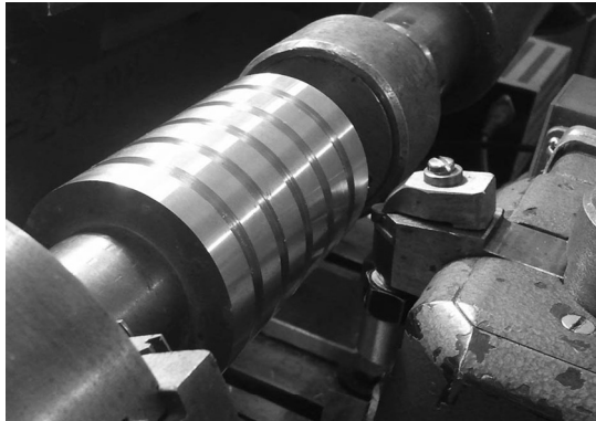
Рис. 1. Резец с датчиком ускорения в динамометре УДМ-100.
