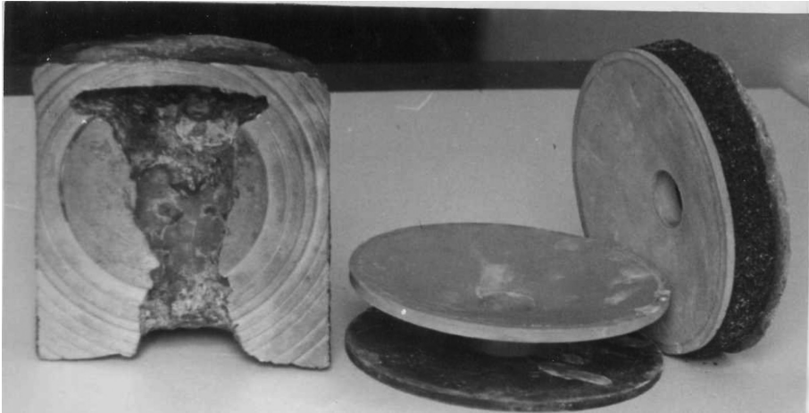
Рис. 3. Перегородка с экзотермической смесью и прибылью, полученная с использованием этой перегородки
