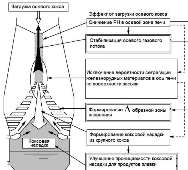
Рис. 6. Схема формирования рационального распределения газового потока при работе с применением ПУТ [12]
