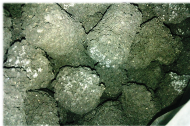
Рис. 6. Брикетированный флюс-модификатор марки «БК-4», размер 40×30 мм
