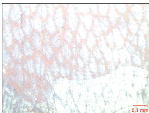
Рис. 4. Неметаллические включения в материале слитка серийно применяемого сплава НВ-4, \times 500 : а – краевая зона; б – центральная зона
