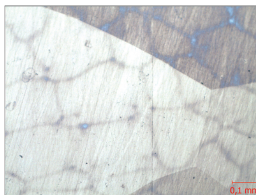
Рис. 4. Неметаллические включения в материале слитка серийно применяемого сплава НВ-4, \times 500 : а – краевая зона; б – центральная зона
