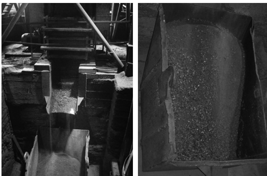
Рис. 2. Дробление огнеупорного лома и получаемый огнеупорный порошок
