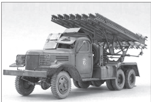
Реактивная система залпового огня БМ-13 «Катюша»
