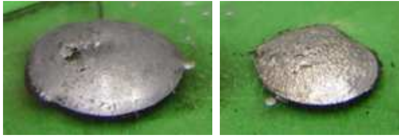
Рис. 5. Фото крапель після змочування \text{SiO}_2 металевими розплавами Pb—5% (мас.) Ti ( a ) і Pb—25% (мас.) In—5% (мас.) Ti ( б ) за температури 550 °C
