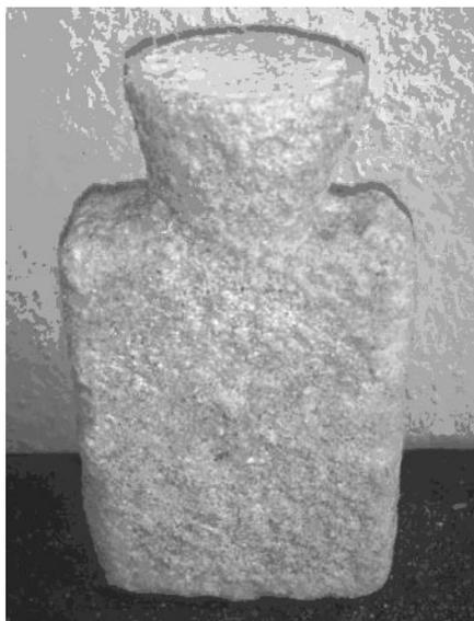
Рис. 1. Многослойные оболочковые формы на жидкостекольном связующем, обсыпочный материал – песок кварцевый
