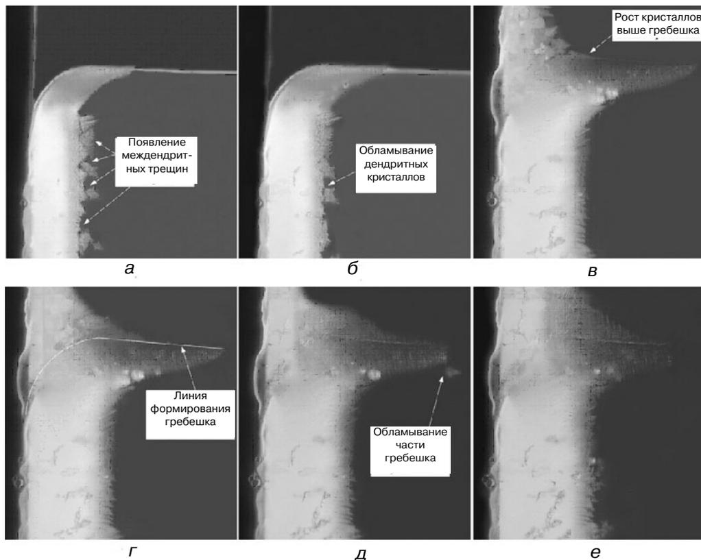
Рис. 3. Поведение дендритов в процессе затвердевания корки слитка
