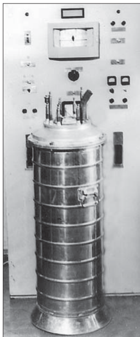
Фото 5. Гелієвий кріостат з надпровідним магнітним екраном з діаметром вхідного отвору 150 мм для метрологічних випробувань надпровідних квантових магніметрів
