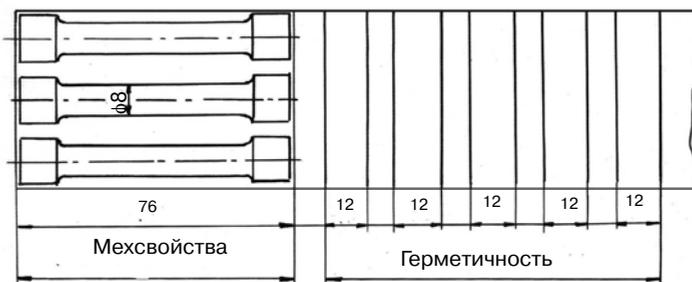
Рис. 3. Схема порезки слитков на образцы для определения механических свойств и герметичности
