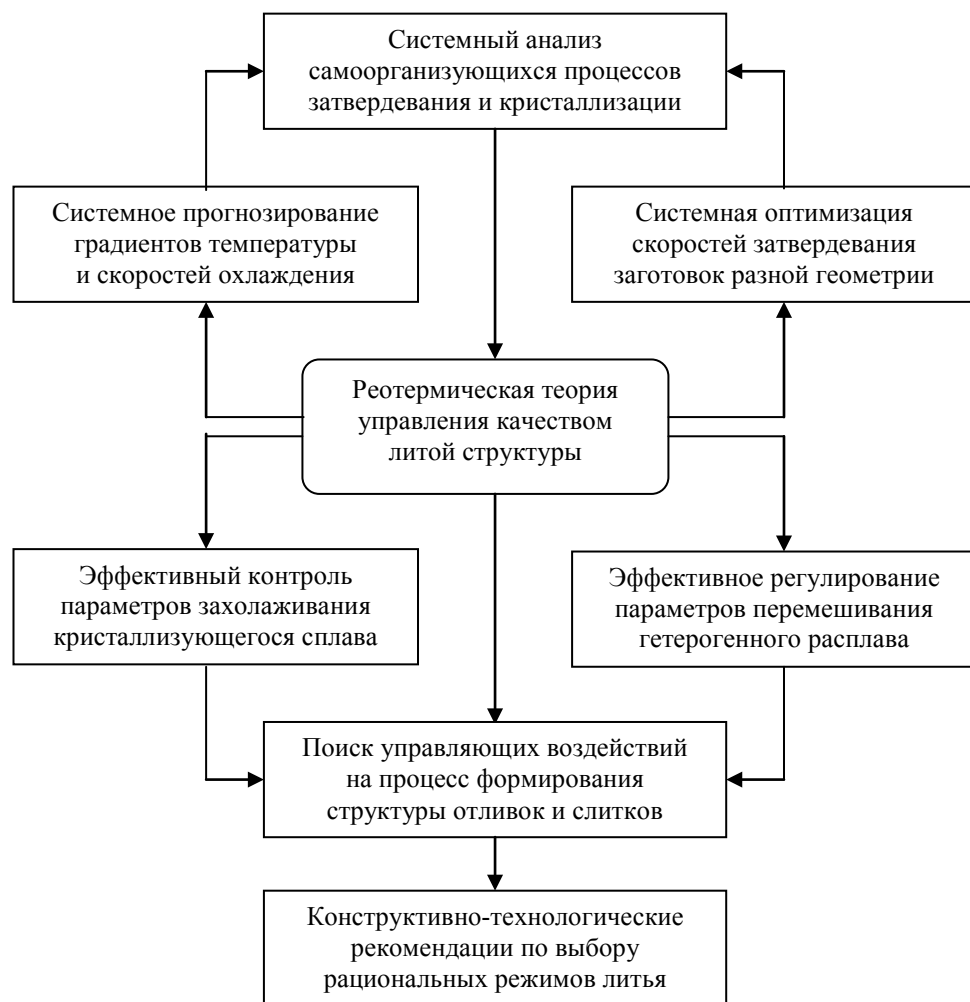
Рис. 2. Системное управление реотермическим процессом формирования литой структуры в двухфазной зоне отливок, слитков и непрерывнолитых заготовок
