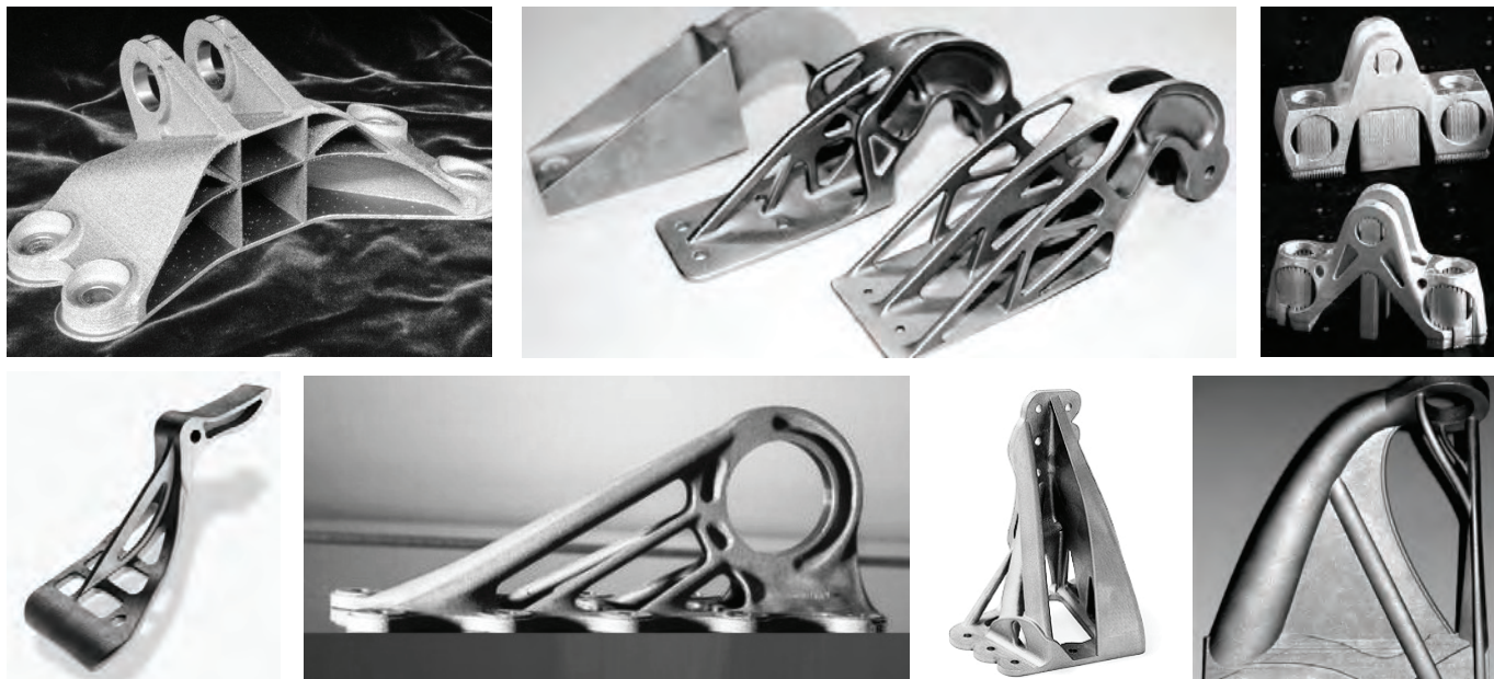
Рис. 3. Варианты 3D-печати различных кронштейнов
