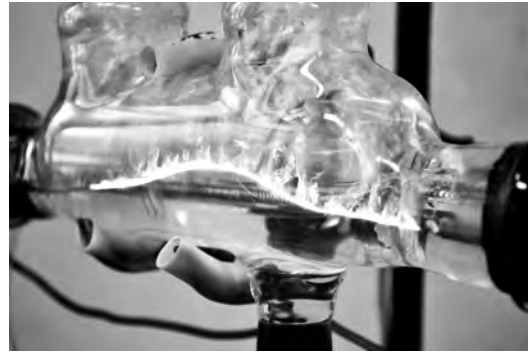
Рис.2. Кризис кипения дистиллированной воды при q_{cr} = 0,7 \text{ МВт/м}^2 .
